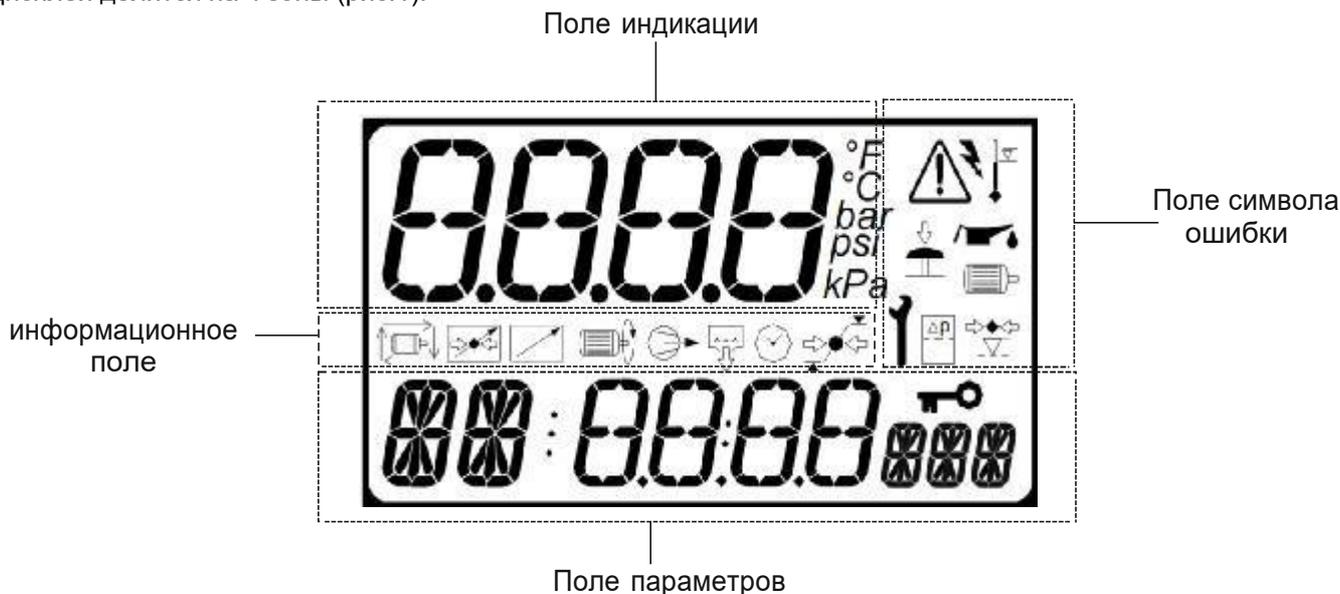
Рис. 1. Дисплей контроллера
